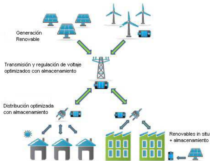
FIGURA 1: Futura infraestructura de las redes eléctricas y posible rol, a varios niveles, del almacenamiento de energía. Fuente: [9]
